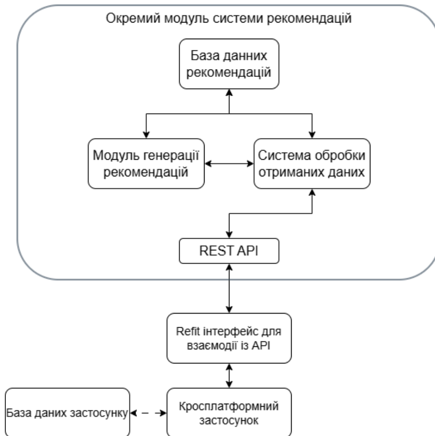
Рис. 2. Взаємодія модуля аналізу користувацької взаємодії із кросплатформним застосунком
